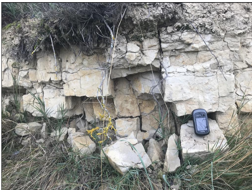
Imagen 7. Calcarenitas margosas nodulares fracturadas
