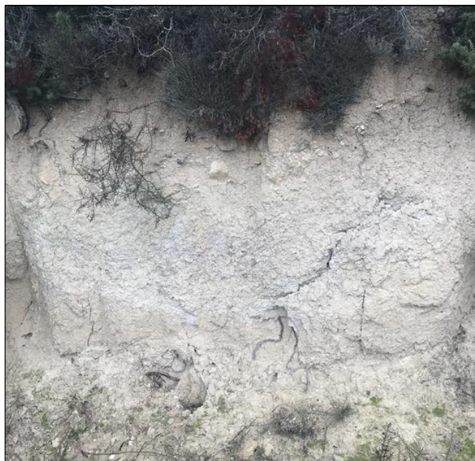
Imagen 10. Perfil de suelos coluviales-eluviales con algún canto a techo
