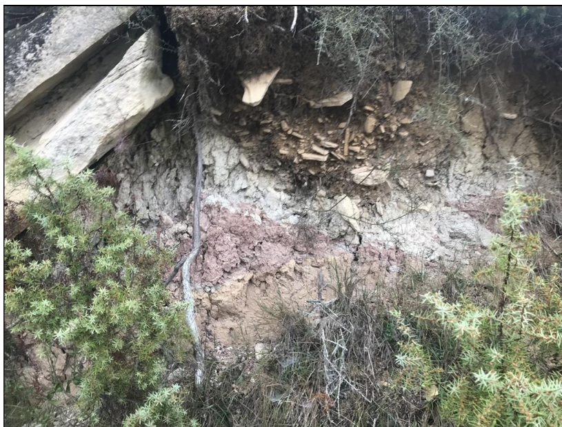
Imagen 11. Suelos coluviales con cantos de arenisca y caliza sobre las argilitas
