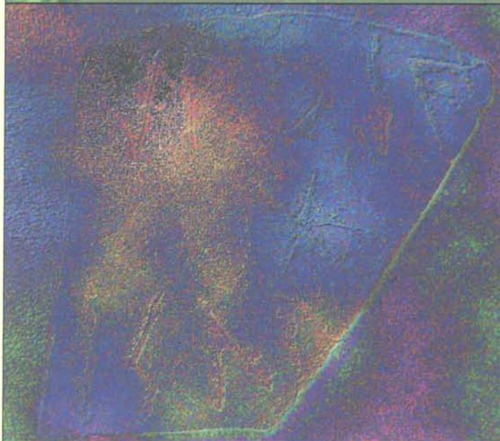
Imagen en falso color. Cada color representa diferentes espesores de elementos traza (media de 3 elementos). Se observan tres tipos distintos de deposición: la zona clara, la zona en azul oscuro y las islas en azul claro.
