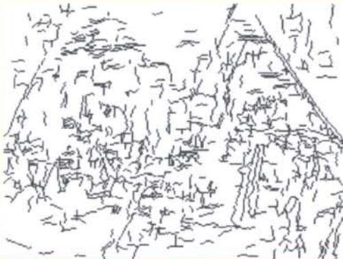
Superficie con escasas estructuras de desconchamiento y bastante uniforme en profundidad media. Existe cambio composicional en el sustrato debido a la existencia de un barniz del cual quedan restos zonificados.
