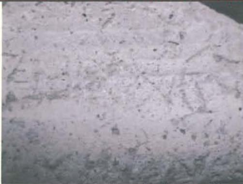
Espectro complejo. El espectro muestra valores dispersos frente al espectro estándar (Al 17.77%, Ca 28.12%, Fe 25.33% y Ti 0.87%). La superficie está bastante erosionada de modo generalizado siendo difícil distinguir estructuras particulares.
