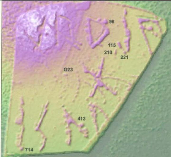
Modelo de elevación digital: integración global de todas las señales al doble de exposición. Comienzan a perfilarse zonas de daño microestructural (parte superior izquierda, canal oblicuo, vacuolas de erosión 96, 115, 210 y 221, microdepresión G23 y dos desconchamientos: 714 y 413).
