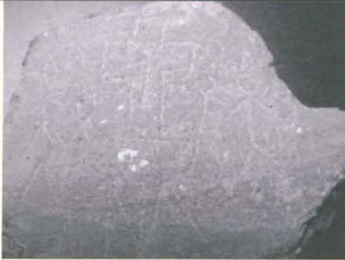
Espectro no lineal. Se trata de una pieza extremadamente compleja debido a que contiene restos de desgrasante, lo que explica la no-linealidad espectral. No es una cerámica como las estudiadas. Presenta numerosas inclusiones minerales de diversa naturaleza que producen un espectro resultado de la superposición de al menos cuatro espectros distintos. Véanse las fotografías ampliadas mostrando grupos y deposiciones exógenas que imposibilitan contar con un espectro de referencia para esta pieza.
