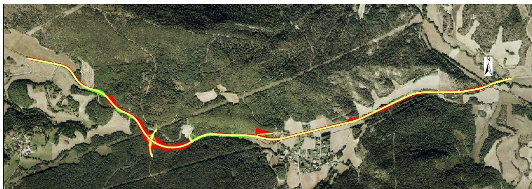
Trazado en el puerto de la Tejera de la alternativa A-1, en rojo las zonas en desmante y en verde las zonas en terraplén
