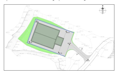
Se prevé su construcción semienterrada para lo cual será necesaria una excavación en talud a media ladera hasta el nivel de apoyo de la solera. Alrededor del depósito se ha diseñado un camino perimetral de hormigón en masa. Asimismo se ha previsto el acceso rodado hasta la sala de válvulas con un vial a ejecutar con capa de rodadura en todo uno.
