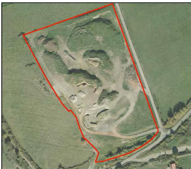
La solución de relleno planteado propone la creación de una superficie sensiblemente horizontal y nivelada, planteando el relleno con tierras y rocas procedentes de excavaciones, desmontes y movimientos de tierra, salvo la capa superior de aproximadamente 30 cm que se completará con tierra vegetal. En la imagen se muestra una proyección aérea:
